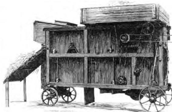
Selvrensende Tærskværk Pris 1000 Kr. med Korner, Elevator, dobbelt Blæst samt med 24" Cylinder.
